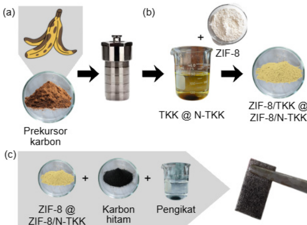
RAJAH 1. Penyediaan (a) sintesis TKK dan N-TKK daripada biojisim kulit pisang melalui kaedah hidroterma, (b) penghasilan nanokomposit ZIF-8/TKK dan ZIF-8/N-TKK melalui kaedah pencampuran larutan dan (c) fabrikasi elektrod positif menggunakan nanokomposit sebagai bahan aktif
