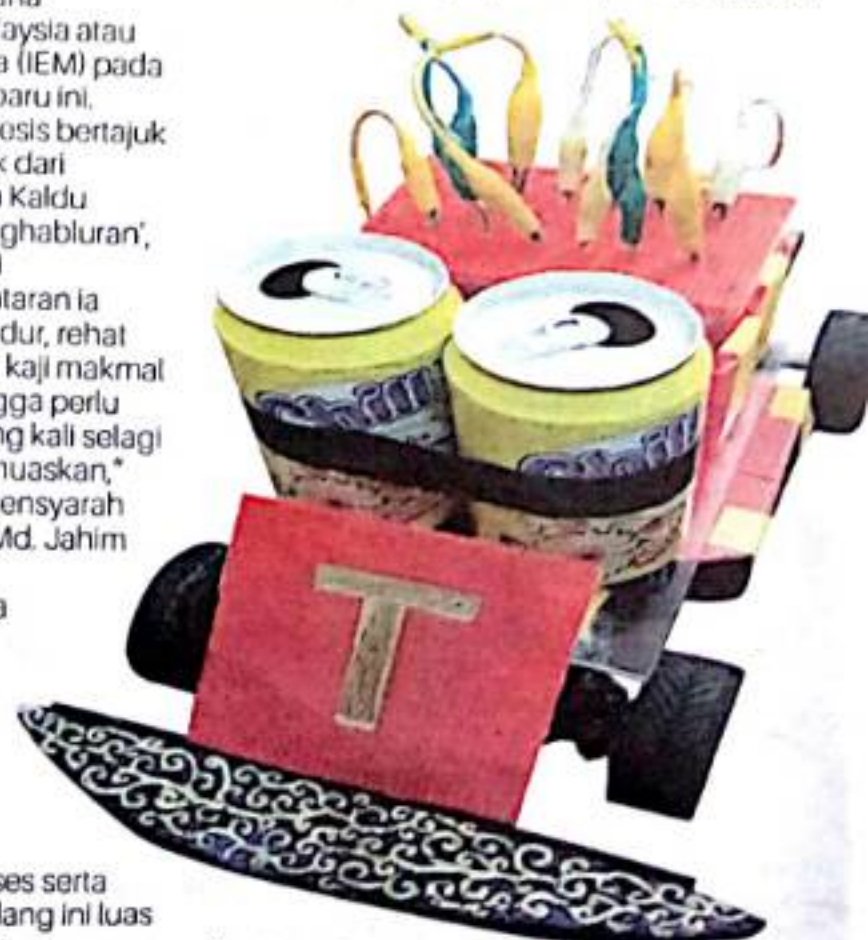
Kereta malnan yang dihasilkan kumpulannya mengguna proses kimia (sel elektrokimia) semasa menyertai Pertandingan ChemE-car Peringkat Kebangsaan Kali Ke-10 (2015).
