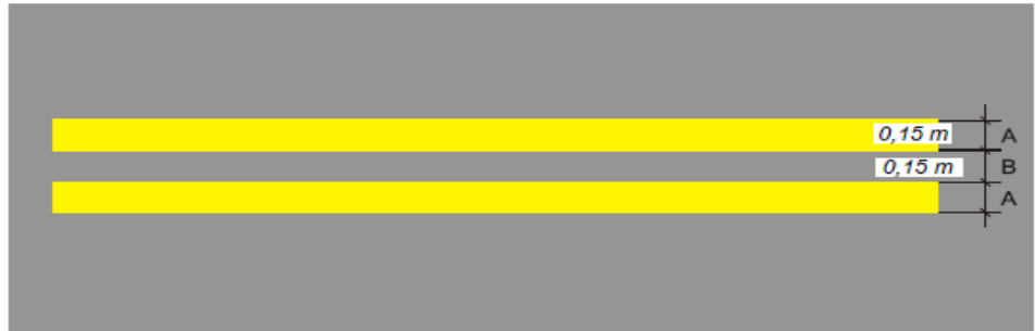
Gambar 5.2-38 : Apron edge markings
