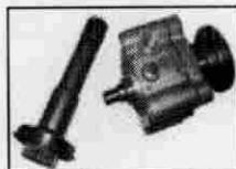
untuk mentransmisikan torsi ke mesin lainnya sehingga memungkinkan putaran mesin untuk menghidupi mesin atau alat lainnya; fungsi: mentransmisikan torsi yang dihasilkan mesin ke mesin atau alat lainnya yang terpisah dari kendaraan; letak: sistem mesin.
