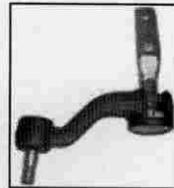
sebagai pivot pendukung; fungsi: sebagai titik pivot pendukung dari gerakan mekanisme sistem kemudi; letak: sistem kemudi.
