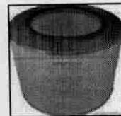
**Air Intake Duct**, saluran tempat masuknya udara luar ke dalam mesin dan sistem lainnya; fungsi: memberikan suplai udara ke mesin dan sistem lainnya; letak: eksterior kendaraan.
