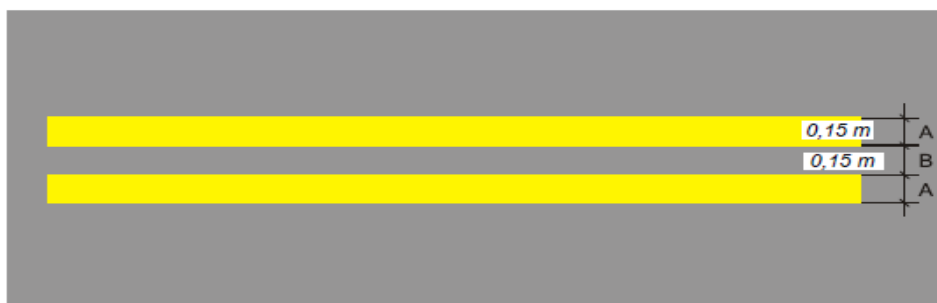
Gambar8.7-3: Apron Edge Markings
