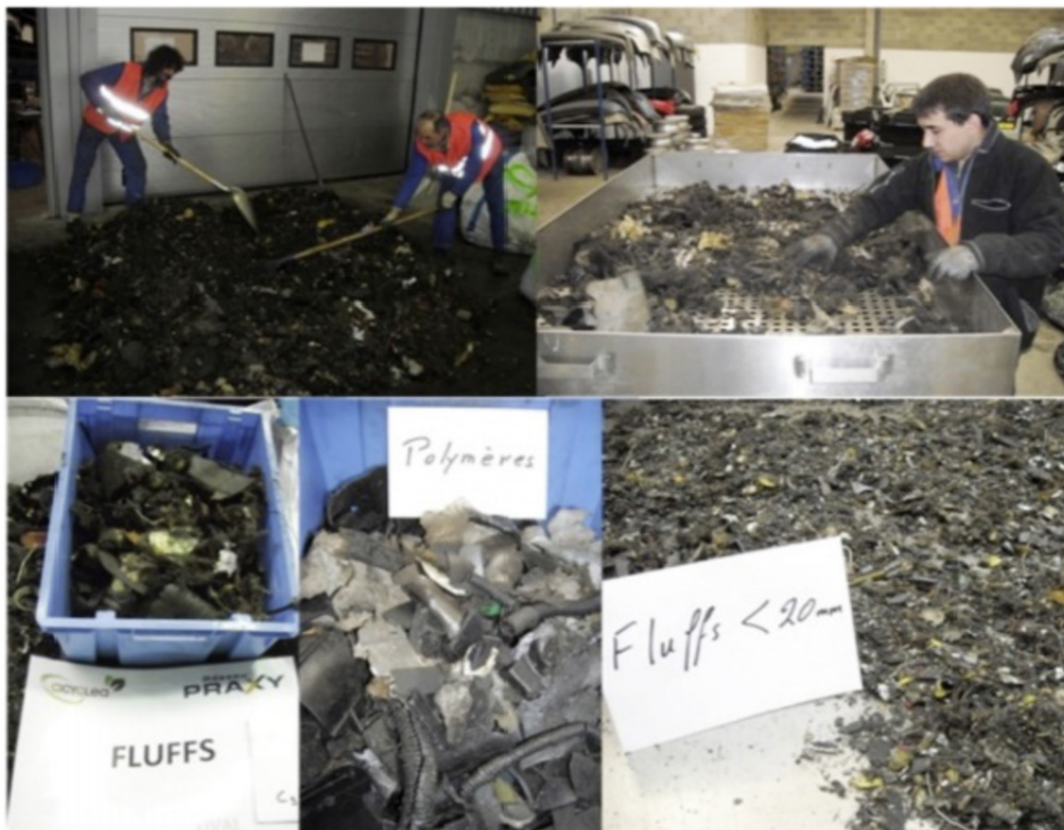
Rajah 2. Beberapa sampel komponen kenderaan yang dihancurkan dan diasingkan untuk dikitar semula (Schmid et al., 2013)
