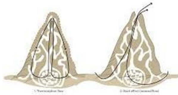
RAJAH 9. Sistem pengudaraan di dalam busut anai- anai (Turner et al. 2008).
