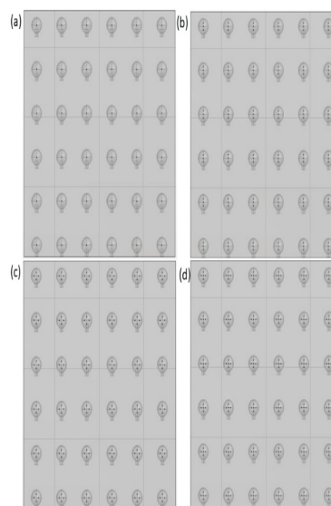
RAJAH 1. Konfigurasi reka bentuk saluran udara keluar (JPAPT): (a) satu lubang (1h), (b) tiga lubang (3h), (c) empat lubang (4h), dan lima lubang (5h).
