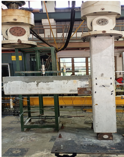
RAJAH 2. Spesimen makmal nib E keluli (Radzi 2023)
