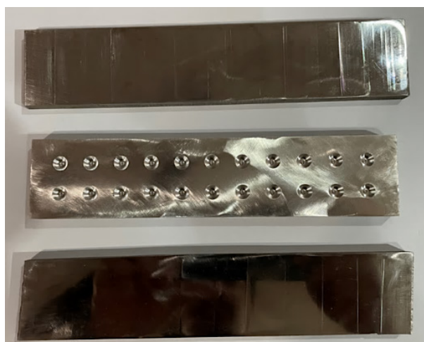
RAJAH 4. Contoh spesimen yang telah siap untuk dicantum
