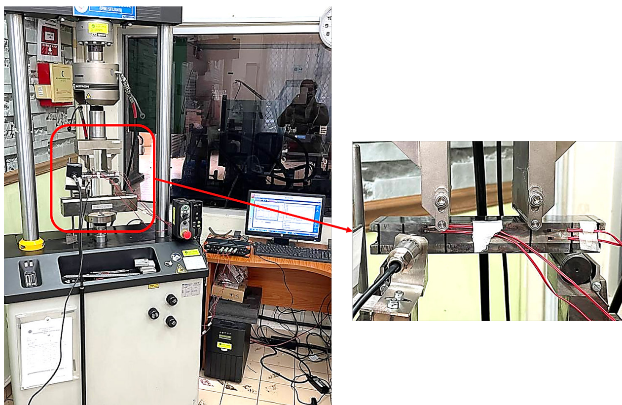
RAJAH 6. Ujian lenturan empat titik berasaskan kepada pembebanan berkitar
