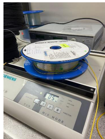
RAJAH 3. Gulungan gentian optik sepanjang 400-meter pada MicroMix 5 Shaker
