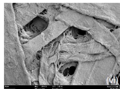
RAJAH 2. Analisis Mikroskop Imbasan Elektron (SEM) kertas serapan Periopaper® (kertas kawalan) dan W595 (kertas ujian). Imej mikroskopik oleh SEM pada kertas serapan Periopaper® (i, ii, iii) dan kertas penapis W595 (iv, v, vi) masing-masing di bawah pembesaran 50 \times , 200 \times dan 1000 \times
